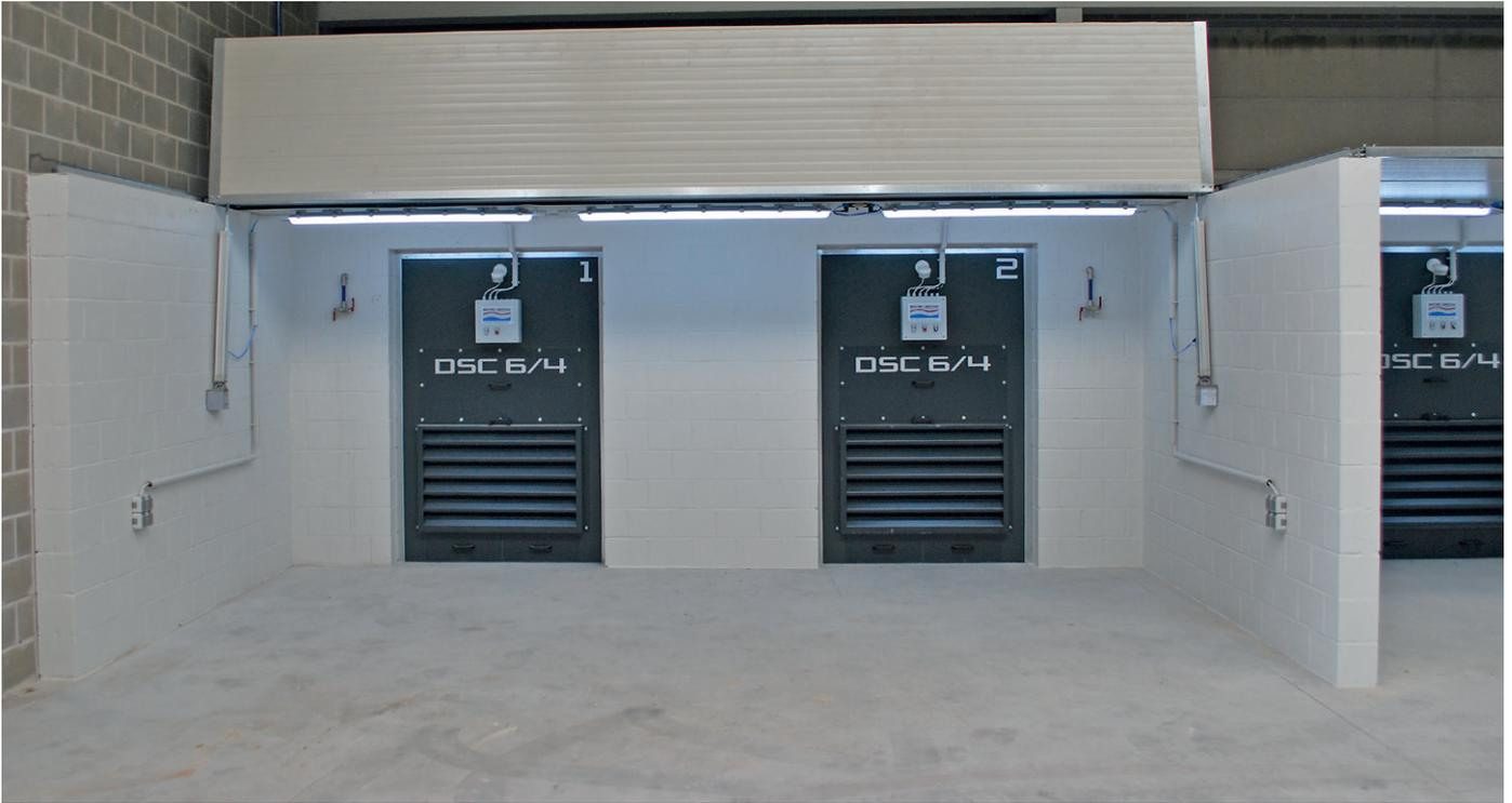
Doppelkabine mit gemauerten Seitenwänden und pneumatisch beweglichem Dach
