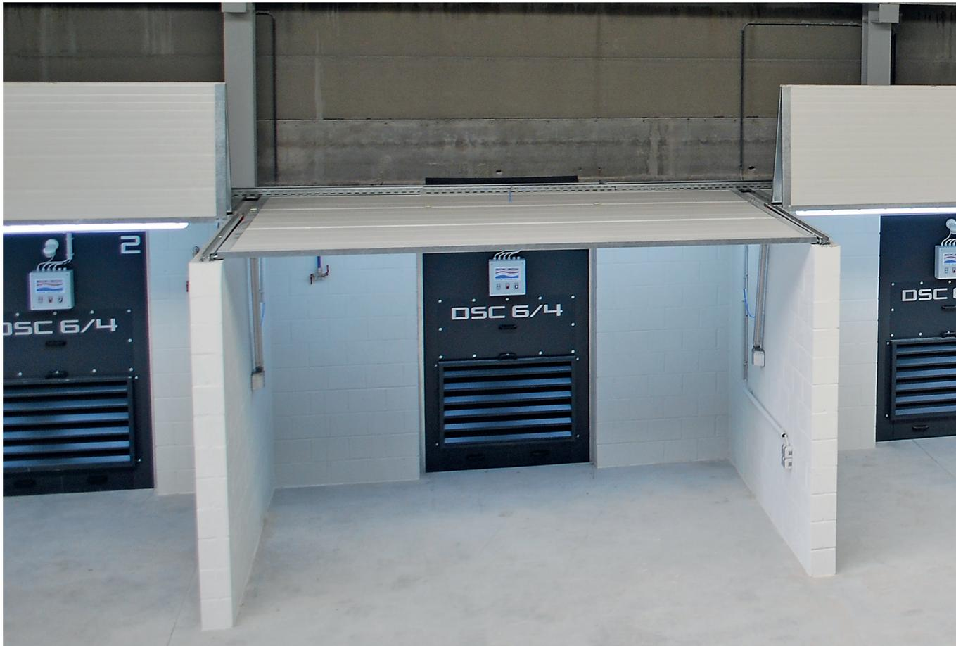
Mehrere Einzelkabinen mit gemauerten Seitenwänden und pneumatisch beweglichem Dach
