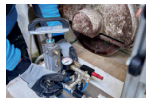
Das Vakuum der Grundplatte wird per Druckluftejektor oder Handpumpe erzeugt. Fotos: weha.com
