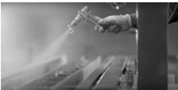
Metallisierung ist ein wichtiger Korrosionsschutz, der bei Maschinen der italienischen Firma Comandulli zum Standard gehört.
