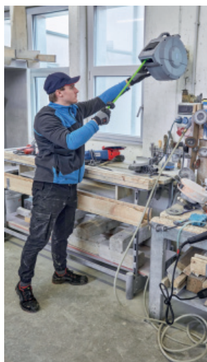
Druckluft nach Maß: Der 15 m lange Schlauch erlaubt einen großzügigen Einsatzbereich rund um den Arbeitsplatz.
